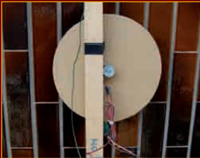
▲ Particolare della parte posteriore del montaggio, in cui si vede bene il motore della spirale e il retro del sensore sonar.
